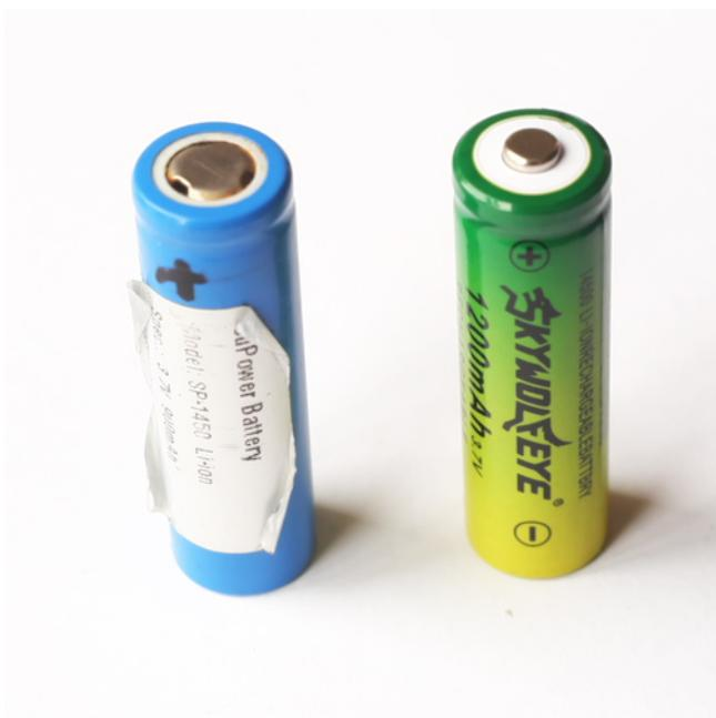
Certains accumulateurs li-ion ont un téton côté positif, d'autres pas. Si les vôtres n'en ont pas, il est nécessaire de tordre un peu les languettes des supports vers l'intérieur.
