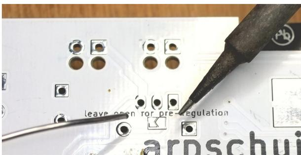
Un (pré)régulateur de tension peut être monté en option. Si vous n'avez pas choisi cette option, faites un pont de soudure entre les deux pads indiqués sur la photo.
