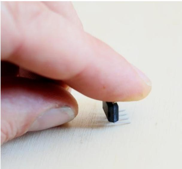
Il est tant de clipper le circuits intégré (MAX3485).
