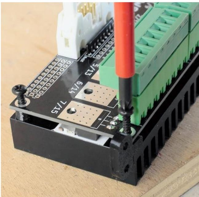
Il ne reste plus qu'à visser progressivement les vis de fixation. Quand les quatre sont au contact, serrez modérément.
