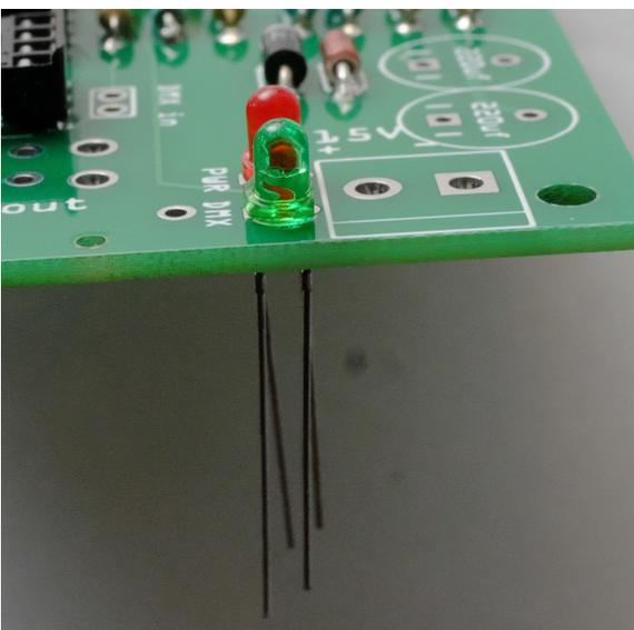
Les leds sont polarisées, une patte est plus courte et il y a un petit méplat sur le corps de la led. Mettre le méplat dans le même sens qu'indiqué sur la sérigraphie. Sur l'arpschuino<sup>2</sup>R<sub>2</sub>, les méplats (et les pattes courtes) sont tournés vers le connecteur d'alimentation.
