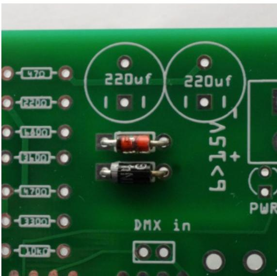
Commencez par les deux diodes, en haut la diode zener et la diode de redressement (noire). Attention les diodes sont polarisées, veillez à ce que l'anneau soit bien positionné comme indiqué sur la sérigraphie.
